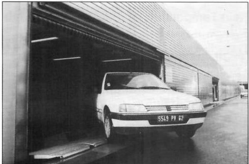
Auffahrtswagen für zweistöckige Pendelzüge für Personenautomobile. Das vordere Einfahrtor führt in das obere Geschoß der Verladewagen, durch das hintere gelangt man in das untere. (Foto: C. Münster)
